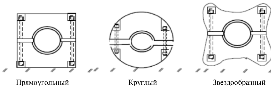
Рисунок 2.4.2 – Различные виды бетонных пригрузов
